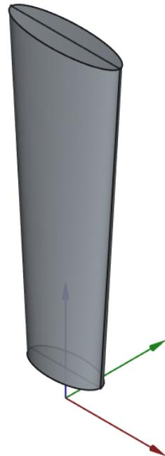
Nervure obtenue par lissage
